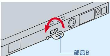
①取り付け部品Bをセキュリティスロットに差し込み90°回転させます。
