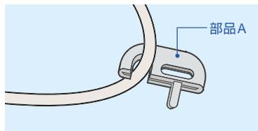
部品Aにマウス、テンキーなどのケーブルを引っ掛けます。(5mmまでのケーブルに対応)
