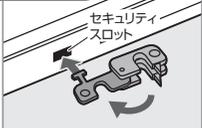
(1) 取付け部品を図のように開き、セキュリティスロットに差し込みます。
