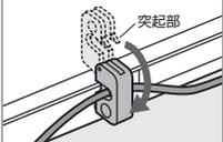
(4) 取付け部品の突起部がセキュリティスロットに入るように閉じてください。
