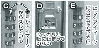
**重要ポイント** 暗証番号を設定して、可変レバーを左上に戻す際画像Cの様に「アイマークのライン」より番号がズレていますと、可変レバーが「左上で固定」されず、画像Dの様に緩い状態になりますので、暗証番号は、画像Eの様にシッカリ「アイマークのライン」に合わせて、可変レバーは「パチッ」と音がして固定した事をご確認の上、ご使用下さい。(画像は暗証番号を「1・2・3・4」に設定した例になります。)
