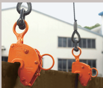
鋼板の堅吊り(2点角度吊り)
