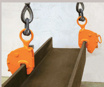
H型鋼の堅吊り(2点角度吊り)
