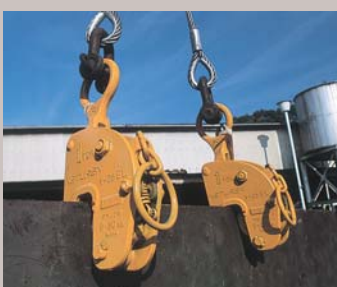
鋼板の堅吊り(2点角度吊り)
