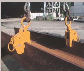
H型鋼の堅吊り(2点角度吊り)
