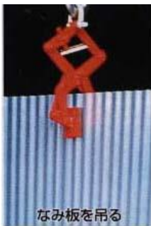
なみ板を吊る
