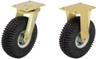
**取付金具:** LS/BSシリーズ - 非常に頑丈な溶接鋼構造、自在旋回部にスラストベアリングDIN 711およびテーパローラーベアリングDIN 720 付き自在取付金具、防塵・防まつ構造、グリースニップル付き、溶接固定された非常に頑丈なセントラルキングピンはボルト締め。ホイール軸はボルト止め。
