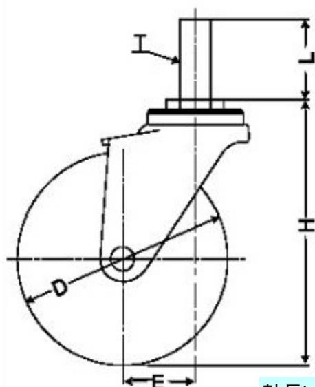
軸長Lmm : 25は、ナットを外した時のねじが切っている部分の長さです。
