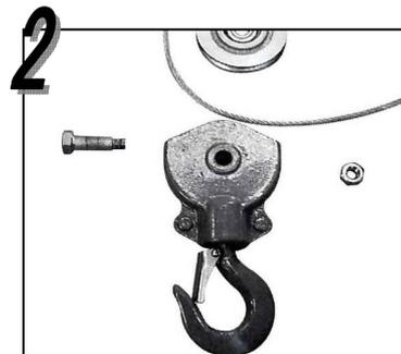
下フック滑車の中心ピンを抜き、ワイヤーを抜きます。
