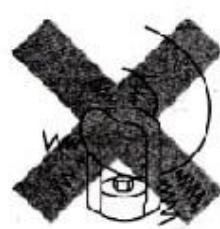
フックやその他の吊り具を直接フレノ・リンクボルトに掛ける場合はリンクの内径より大きなフック類は絶対にご使用にならないで下さい。
