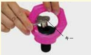
キーをボルト上部に差し込み、リングとボルトを固定します。
