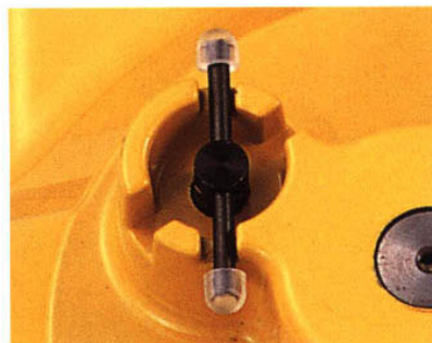
ドラムロック機構 工具類の交換を容易にするためドラムをロックできます。
