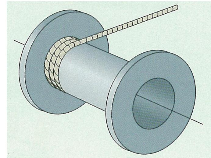
ロープの端末止めである捨て巻き(余巻き)を確実に行う為にドラムには3巻き以上ロープを残してください。
