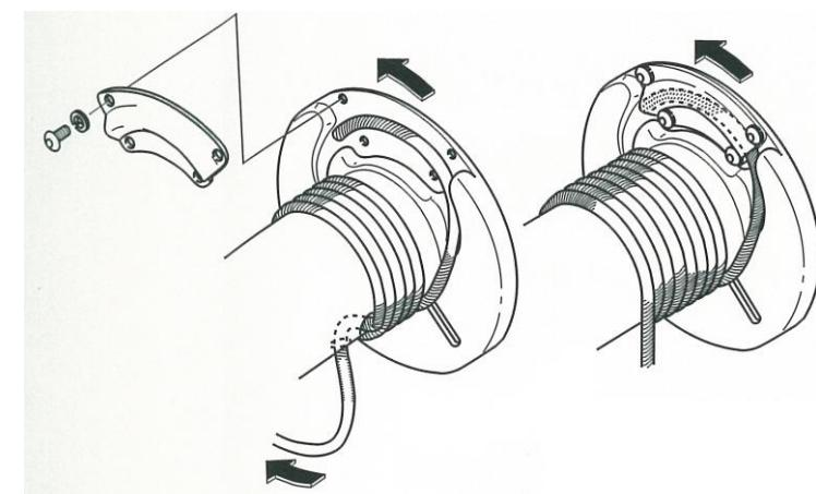
ワイヤーロープの固定は捨て巻き(余巻き)が確保される二重構造になっており、付属の六角L型レンチで簡単に取り付けできます。
