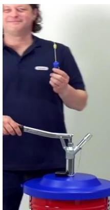
4 注入ノズルの穴を細い棒で押しながら表面にグリースが出るまでハンドレバーを作動させ、出たグリースを取る。
