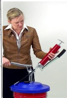
5 注入ノズルの先に充填ニップルの先を挿入し、片手でガンをしっかり保持して、12回ハンドレバーを作動させるとほぼ満タンになります。
