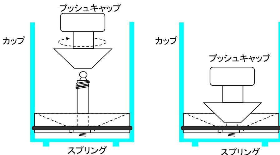
そしてピストンを下まで押しつけて離します。ピストンのスプリングは真空状態を破ります。
