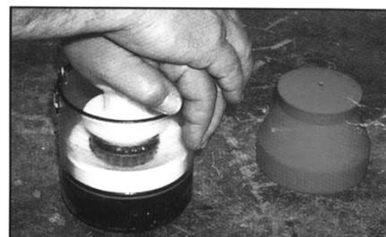
4. カップが空になったら、ピストン軸にプッシュキャップをねじ込みます。
