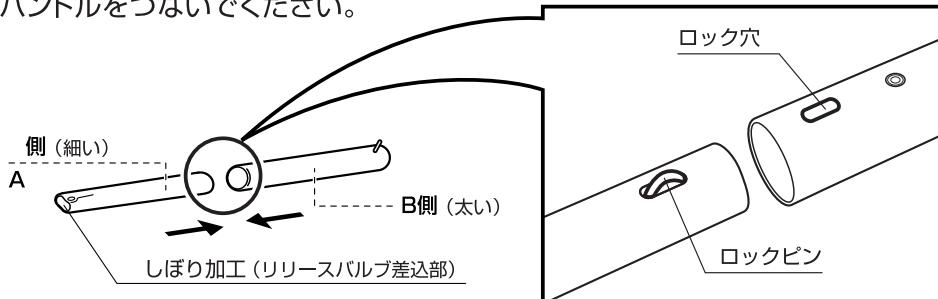
3) ハンドルのA側のしづりをリリースバルブに差し込み、時計方向に回してリリースバルブを締めます。※リリースバルブの締め付けが不十分な場合、ジャッキアップしなかったり、下がってきたりしますのでしっかりと締めてください。
