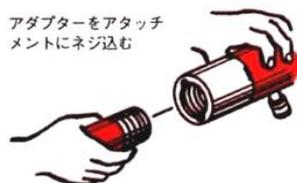
キャップ・スクリューで、このアクセサリをシリンダー・ベースに取り付けます。このアタッチメントには、数多くのオス型アダプターをネジ込むことができます。
