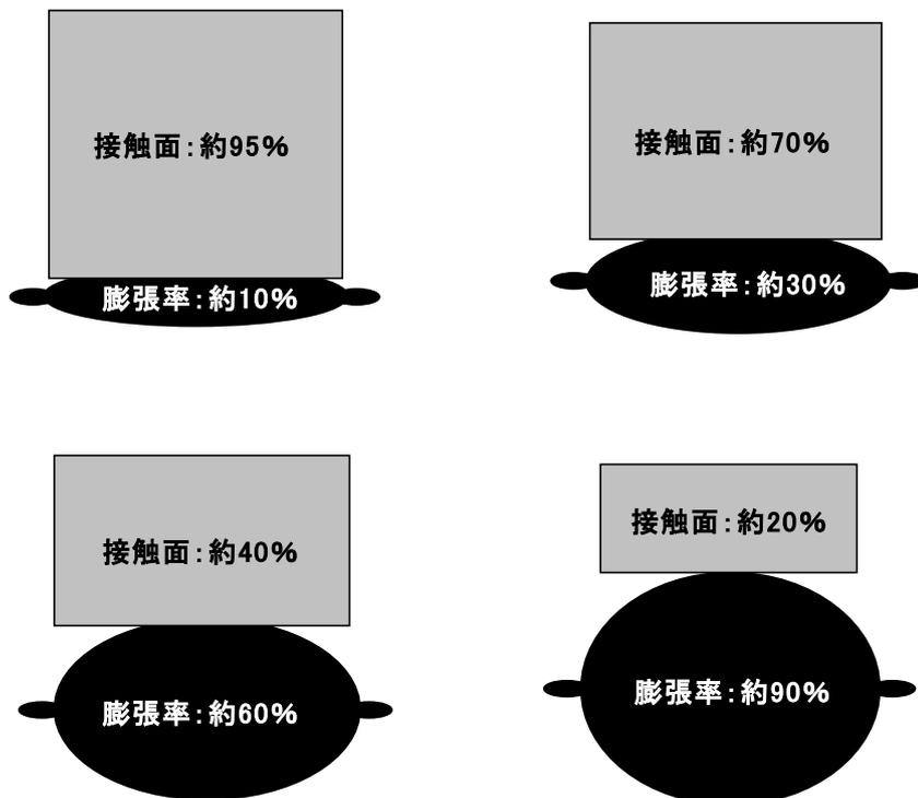
★インフレーターブルマットジャッキは持ち上げ高さにより、能力 (ton) が大きく変化致します。
