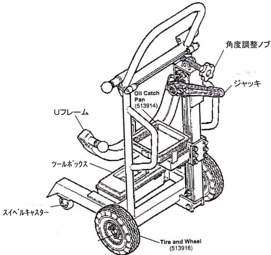
○ Uフレームにアダプター(別売)を取付けます。そのアダプターにドラムを取付けます。
