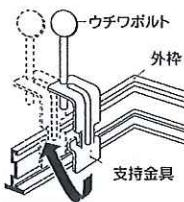
◆ボルトを手で回しながら、取付け用チャンネルに、4つとも固定して下さい。
