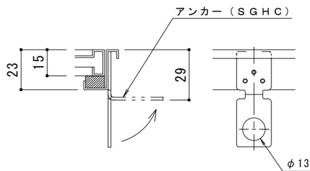
※アンカーは施工時に現場にて折り曲げて下さい
