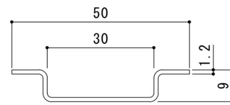
補強材詳細図 S = 1 : 1
