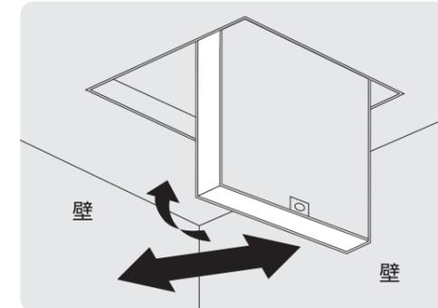
注) 壁を傷つけないように、内枠は壁と反対側に開くように取り付けてください。
