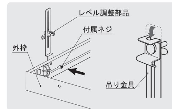
■ 外枠の取付方向確認後、吊り金具を内側から付属ネジで取り付けてください。レベル調整部品の蝶ナットをゆるめチャンネルにレベル調整部品を引っ掛け、蝶ナットをしっかりと締め付けてください。
