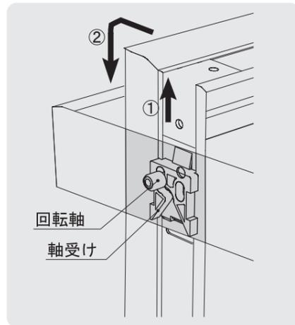
③内枠を矢印①の方向に押し上げ、軸受けを回転軸から外し矢印②のように内枠をスライドして取り外してください。
