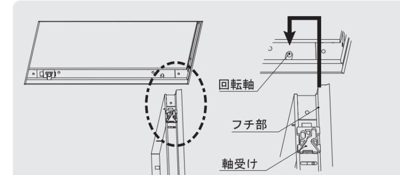
①内枠を外枠と回転軸との間から入れ、内枠のフチ部に回転軸が沿う状態で下方にスライドさせながら、内枠の軸受けに回転軸がカチッと音がるまで、はめ込んでください。
