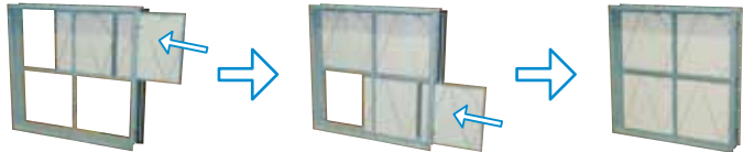
フィルタを入れる前に、連結器に予めヒッカケて連続して差し込みます。
