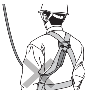
ランヤードが腋にある状態
