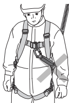
ランヤードが腋にある状態
