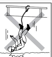
3. フックは正しく掛けしてください。誤った掛け方をしますと墜落制止時に構造物から外れる危険性があります。
