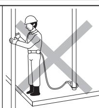
2. ランヤードに表示された落下距離を確認し、それ以下の位置で作業を行わない。墜落制止時に床面又は下方の障害物に接触する恐れあります。
