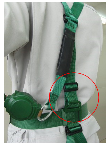
③吊りベルトと背ベルトの接続部が切れる。
