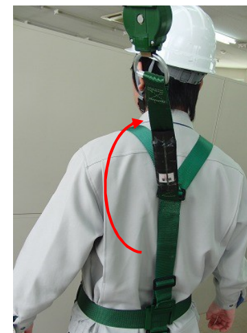
④吊りベルトが反転して人体の落下を阻止する。
