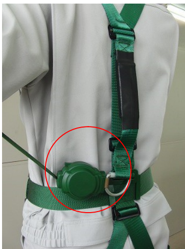
②巻取り器裏側のベルト通し部が切れる。
