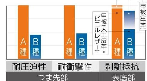
JSAAとは、つま先に保護先芯を搭載したスニーカータイプの安全基準を定めた規格です。
