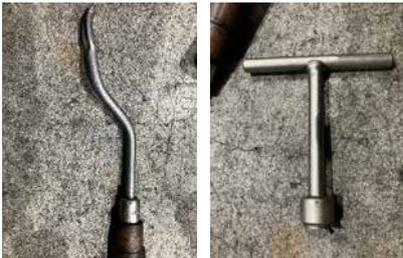
既製品を溶接し、自作工具を作成している...
