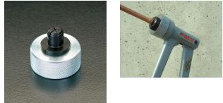
銅、アルミ、軟鋼管を継手なしで早く、かつ正確に接合することができます
