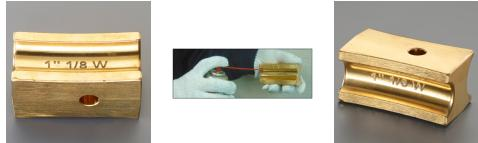
ベンダー用ガイドに潤滑材を塗布して曲げ作業を行なうと、銅管への負担が減少し、きれいな仕上がりになります。
