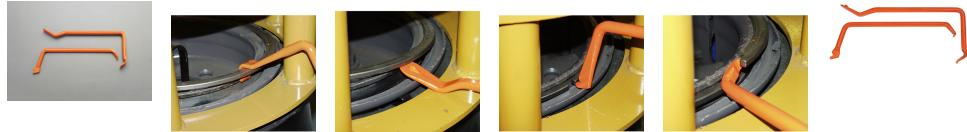
工業用フォークリフトホイールのロックリングの脱着に最適です
