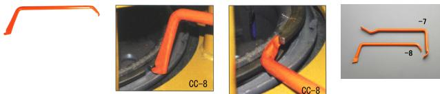
工業用フォークリフトホイールのロックリングの脱着に最適です
