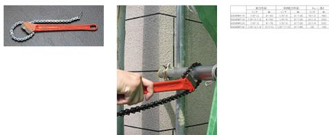
双方向に設けられたジョーの働きで、正逆それぞれの回転方向に対応し、ラチェットのように使用できます
