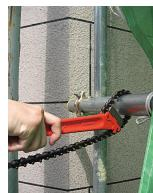
双方に設けられたジョーの働きで、正逆それぞれの回転方向に対応し、ラチエットのように使用できます
