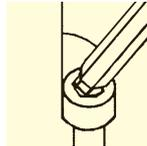
先端に段が設けられており、使用場面に応じて90度、100度とアングルを変えて使用が可能です。
