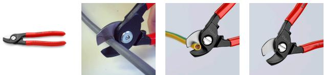
$\phi$  15mmのケーブルも片手で滑らかに切断
