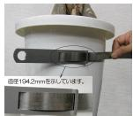
円柱の物体に巻きつけて、目盛を見るだけで計測できます
