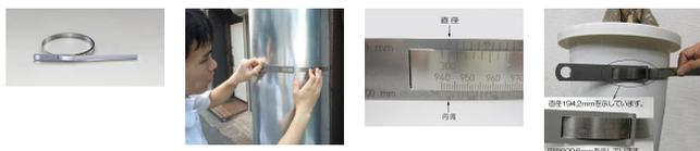
円柱の物体に巻きつけて、目盛を見るだけで計測できます
