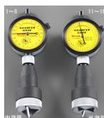
面取り穴に直接プランジャーを押し付けることで直径を測定します
