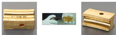
ベンダー用がガイドに潤滑材を塗布して曲げ作業を行なうと、銅管への負担が減少し、きれいな仕上がりになります。
