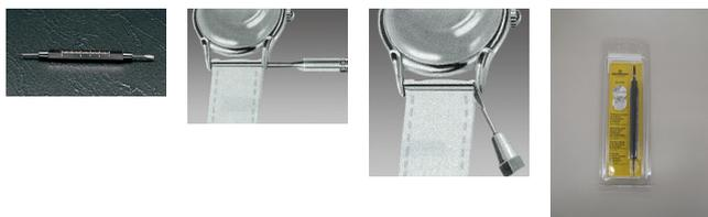
先のとがった方は金属バンドのピン抜き、又の方は革バンドのスプリングピン抜き
