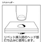
リベット挿入時のヘッド部打ち込みに使用します。
