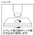
リベット挿入時のヘッド部打ち込みに使用します。
