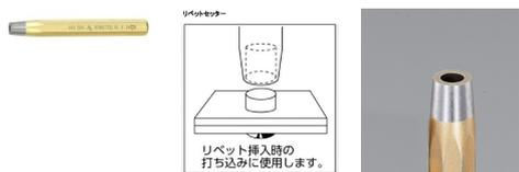
リベット挿入時の打ち込みに使用します。
