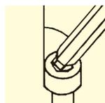
ボールポイントマークの無きボールポイントレンチは、ボールを損傷させる原因となります。ボールポイントマークの付いたボールポイントレンチを使用してください。
