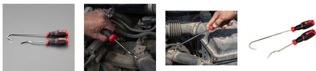
幅広形状の先端でホースへの損傷を軽減します。
