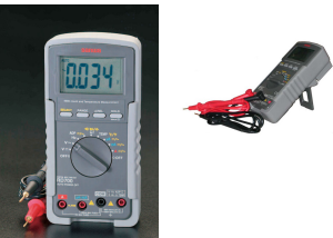
高入力インピーダンス 1000MΩ(400mVレンジ)
