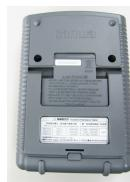
定格500V 最大目盛100MΩ アナログ単レンジ式 漏電回路の特定を目的とした現場測定器
