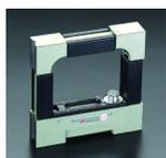
微調整ダイヤル付き、4つの測定面で2つのV溝
